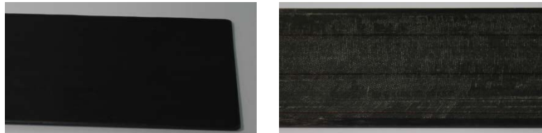
Figura 1: A sinistra lamina pultrusa senza peel play mentre a destra con peel play
