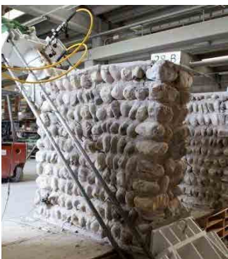
12. Campioni in muratura di pietra (sinistra) e ciottoli (destra) rinforzato con "Reticolatus" al termine della prova.
