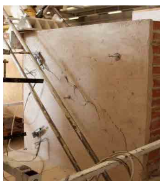
13. Campione in muratura di laterizi con rinforzo ibrido.
