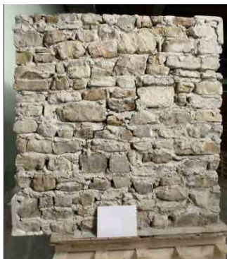
11. Campione non rinforzato in muratura di ciottoli: a sinistra durante l'esecuzione della prova, a destra dopo la rimozione del carico.
