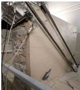
14. Campione in muratura di pietrame con rinforzo ibrido.
