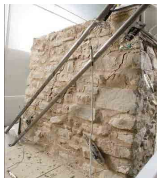
14. Campione in muratura di pietrame con rinforzo ibrido.
