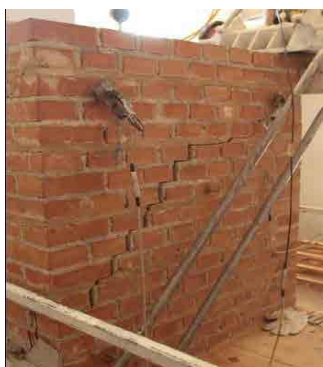
13. Campione in muratura di laterizi con rinforzo ibrido.
