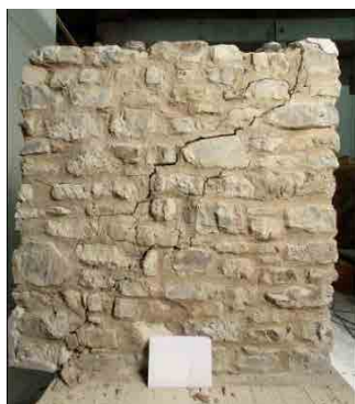
13. Campione in muratura di laterizi con rinforzo ibrido.
