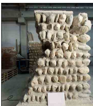
12. Campioni in muratura di pietra (sinistra) e ciottoli (destra) rinforzato con "Reticolatus" al termine della prova.
